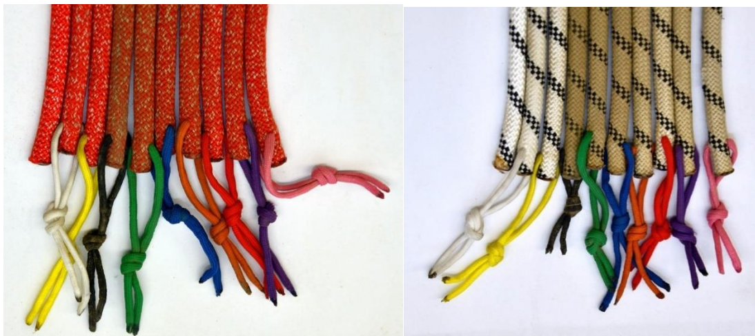
Ansicht der Seile nach zehn Waschvorgängen (rot – dynamische Seile, weiß – statische Seile)
